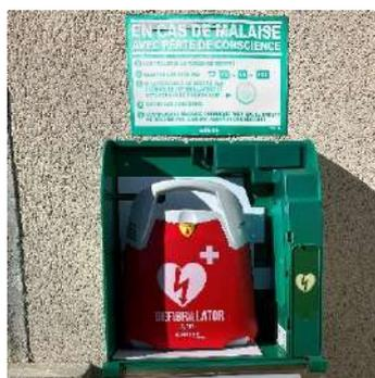
Un défibrillateur est un appareil portable, fonctionnant au moyen d'une batterie dont le rôle est d'analyser l'activité du cœur d'une personne en arrêt cardio-respiratoire. Cette analyse est entièrement automatique, ce qui évite à l'opérateur toute prise de décision. Seuls des chocs externes sont possibles, c'est-à-dire que les électrodes sont placées sur la peau du patient. Si elle détecte un rythme choquable, la machine permet de délivrer un choc électrique ou « défibrillation ».
